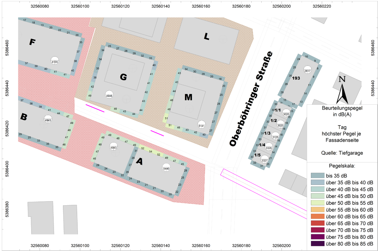
Abbildung 1: Beurteilungspegel Tag, Quelle: Tiefgarage und Parkhaus
