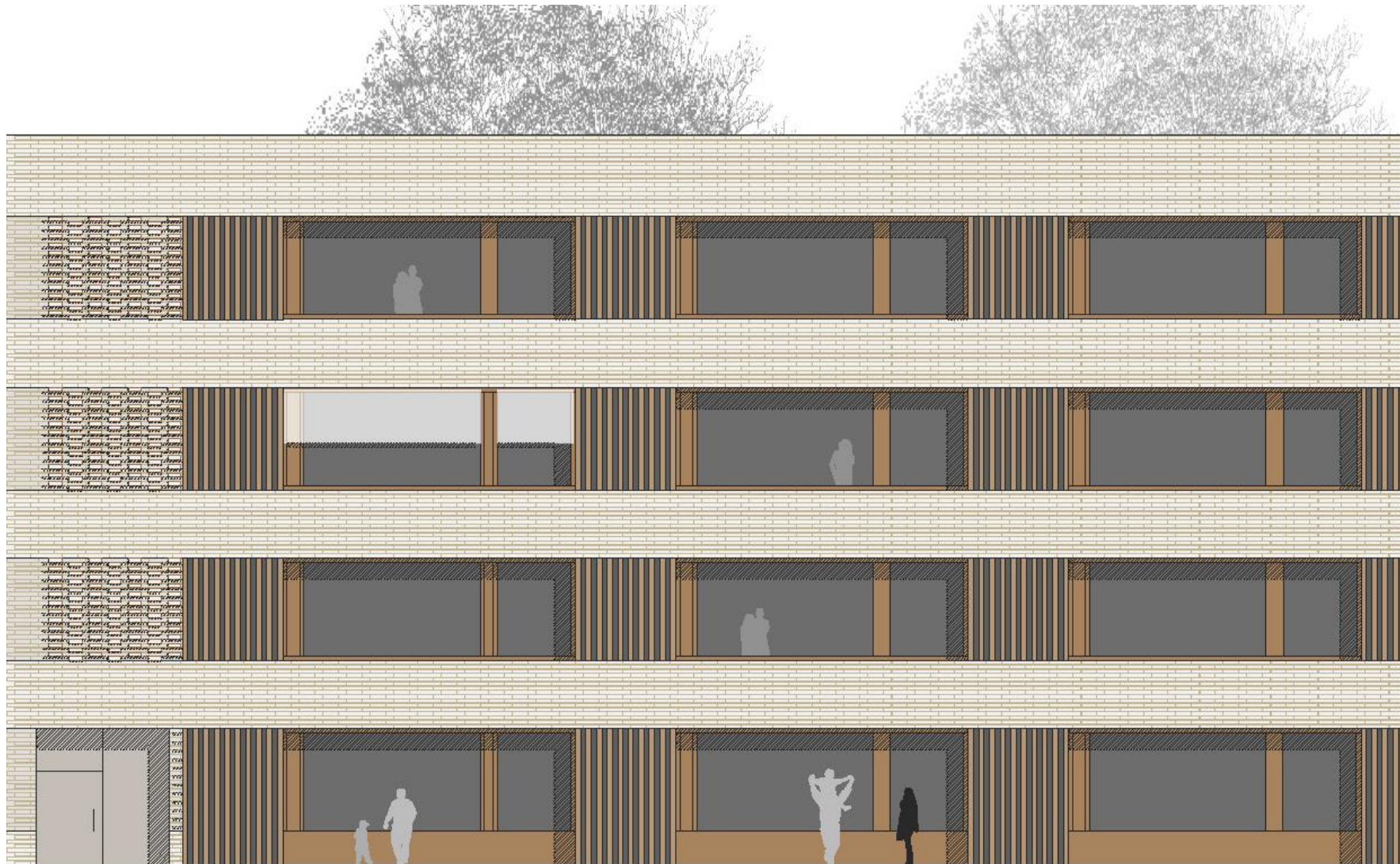
V2c Ziegelfassade Alu-Filterstruktur, Festverglasung
