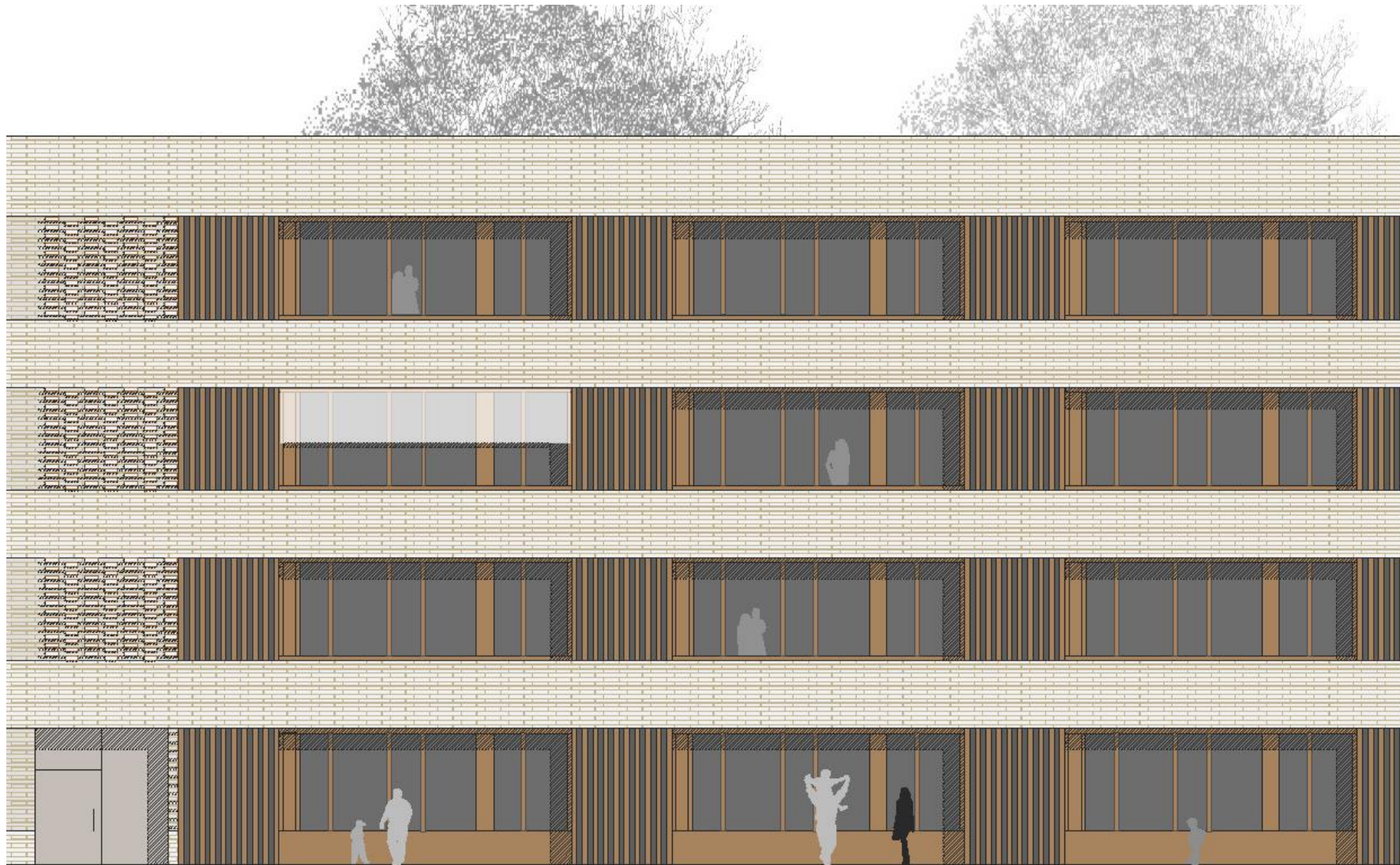
V2b Ziegelfassade Alu-Filterstruktur, Öffnungsflügel
