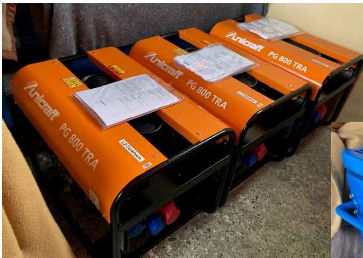
Drei Notstromaggregate (8 KVA) für die FW-Häuser Stötten, Weiler und Türkheim.
